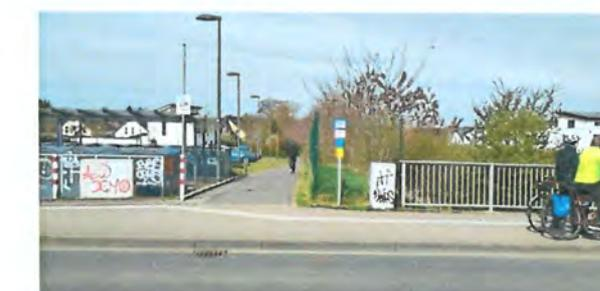
Foto 10: Die Einmündung an der S-Bahn-Station „Im Siegbogen“ sollte verbreitert und der Bordstein entfernt werden.
