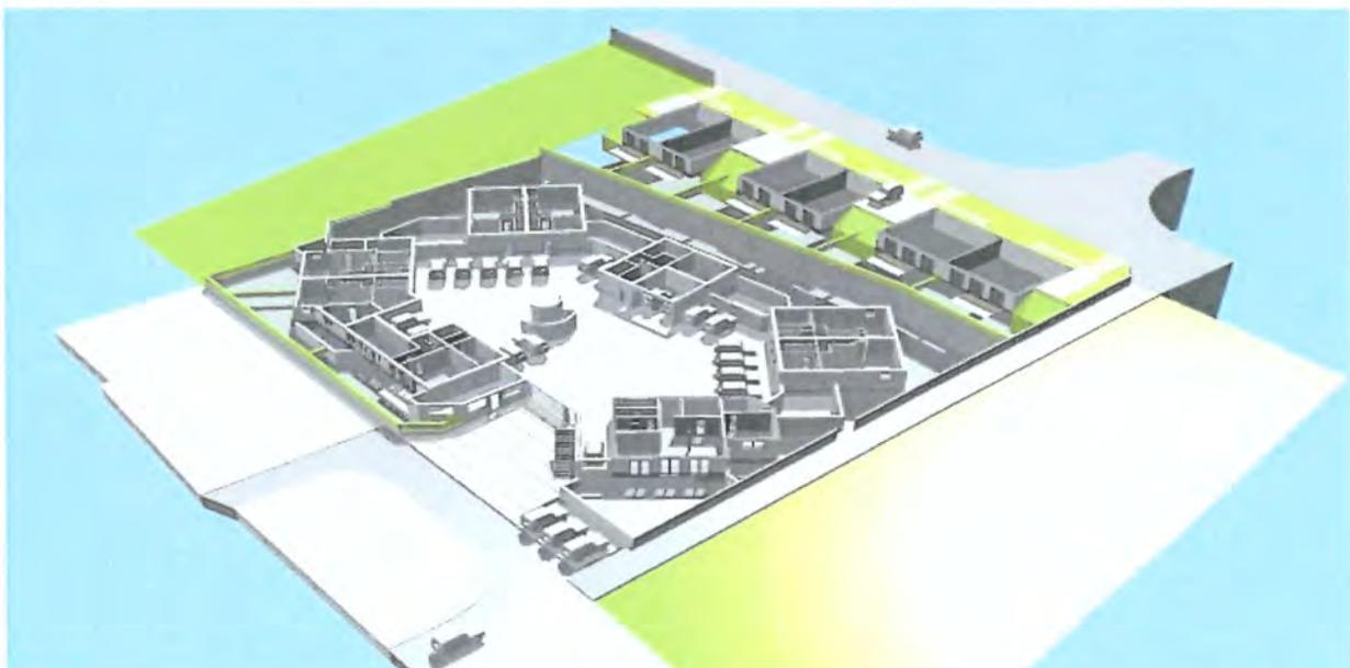
Abbildung 9: Verkehrskonzept: Tiefgarage mit 20 Stellplätzen und 3 öffentlichen Stellplätzen im Einfahrtbereich, sowie einer Wendemöglichkeit für die Müllentsorgung. Gleichzeitig dient der „Vorplatz“ als Aufstellfläche für die Feuerwehr.
