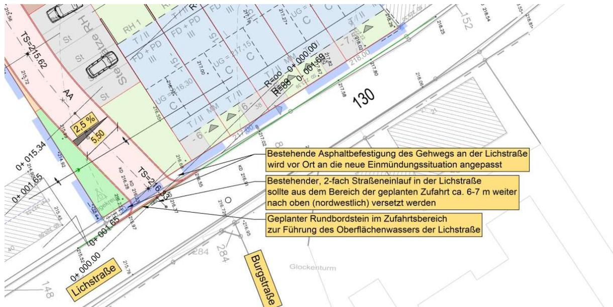
**Abb. 20: Fachplanung zur Verkehrserschließung, Anbindung an die Lichstraße (Quelle: Ingenieurbüro Brenner GmbH)**
