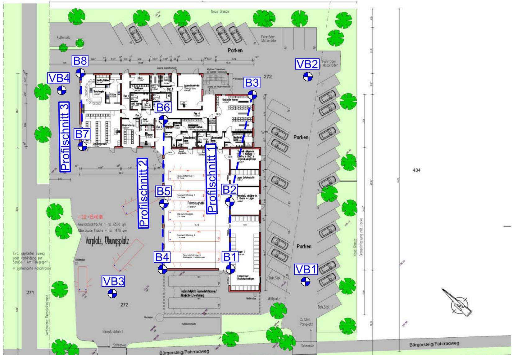
B = Rammkernbohrung Ø 50/36 mm
