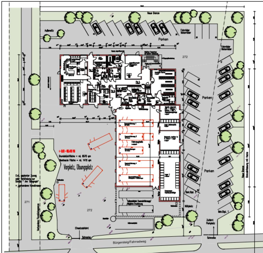
Abb. 11: Vorentwurf des Konzeptes für den Neubau der Feuerwehr
