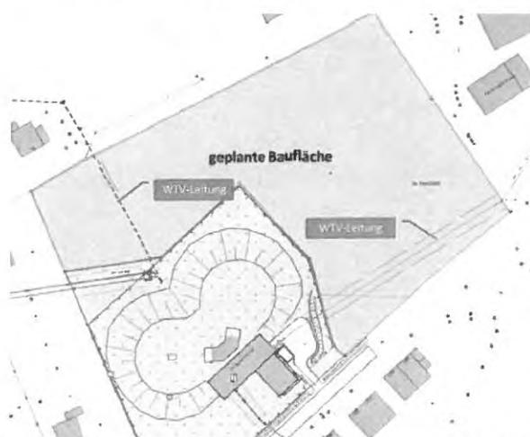
der geplanten Baufläche und der Lage der beiden Rohrleitungen, die diese Fläche kreuzen.
