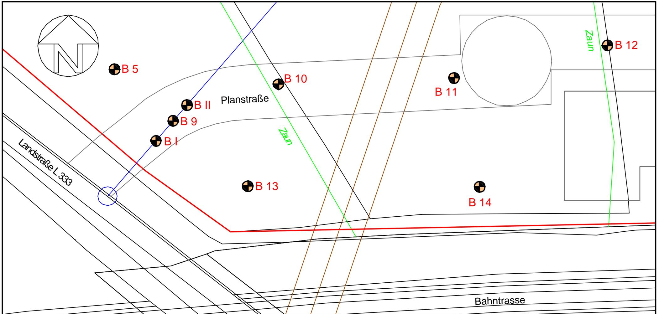
B = Rammkernbohrung  $\varnothing$  40/36 mm
