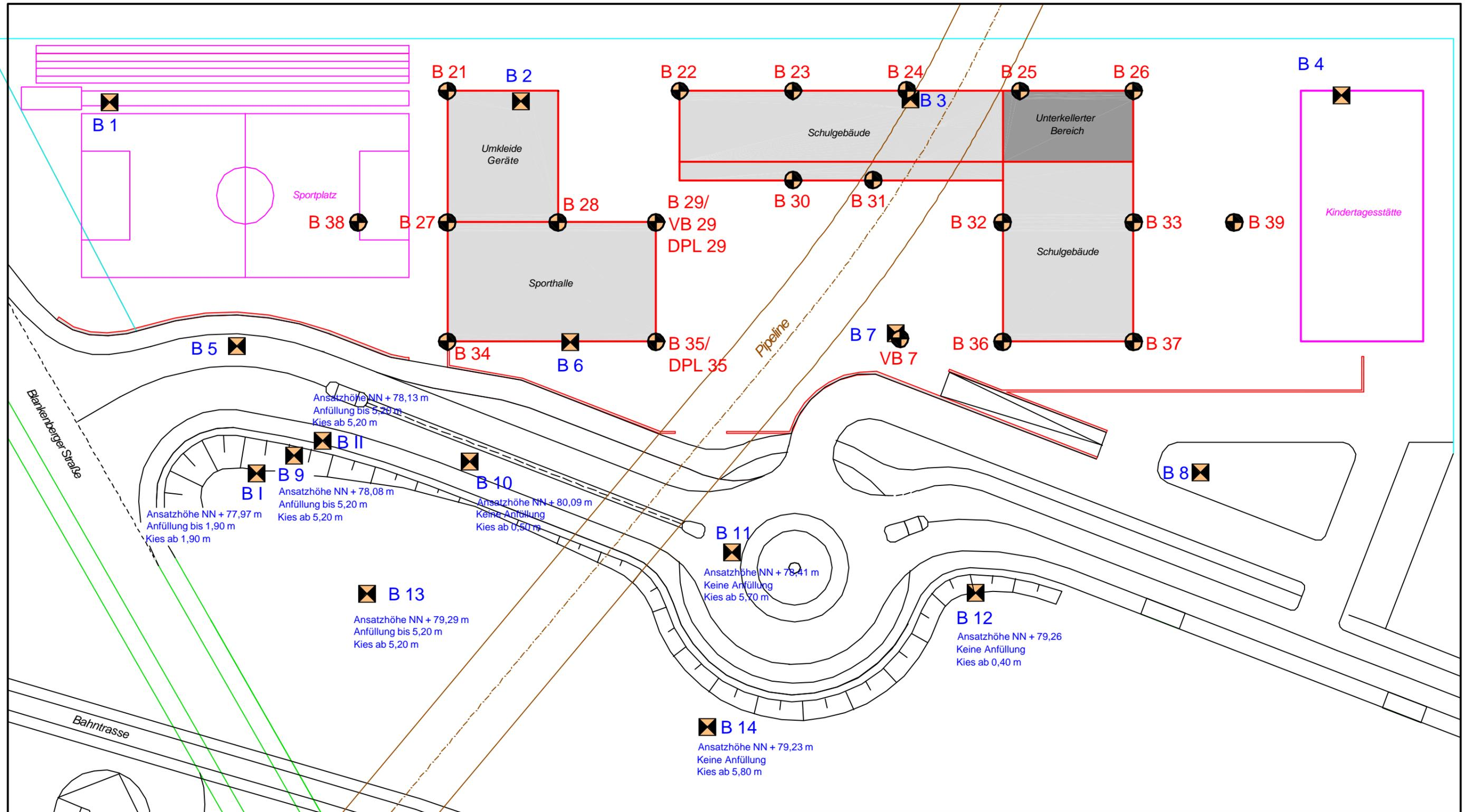
B = Rammkernbohrung Ø 36/42 mm
