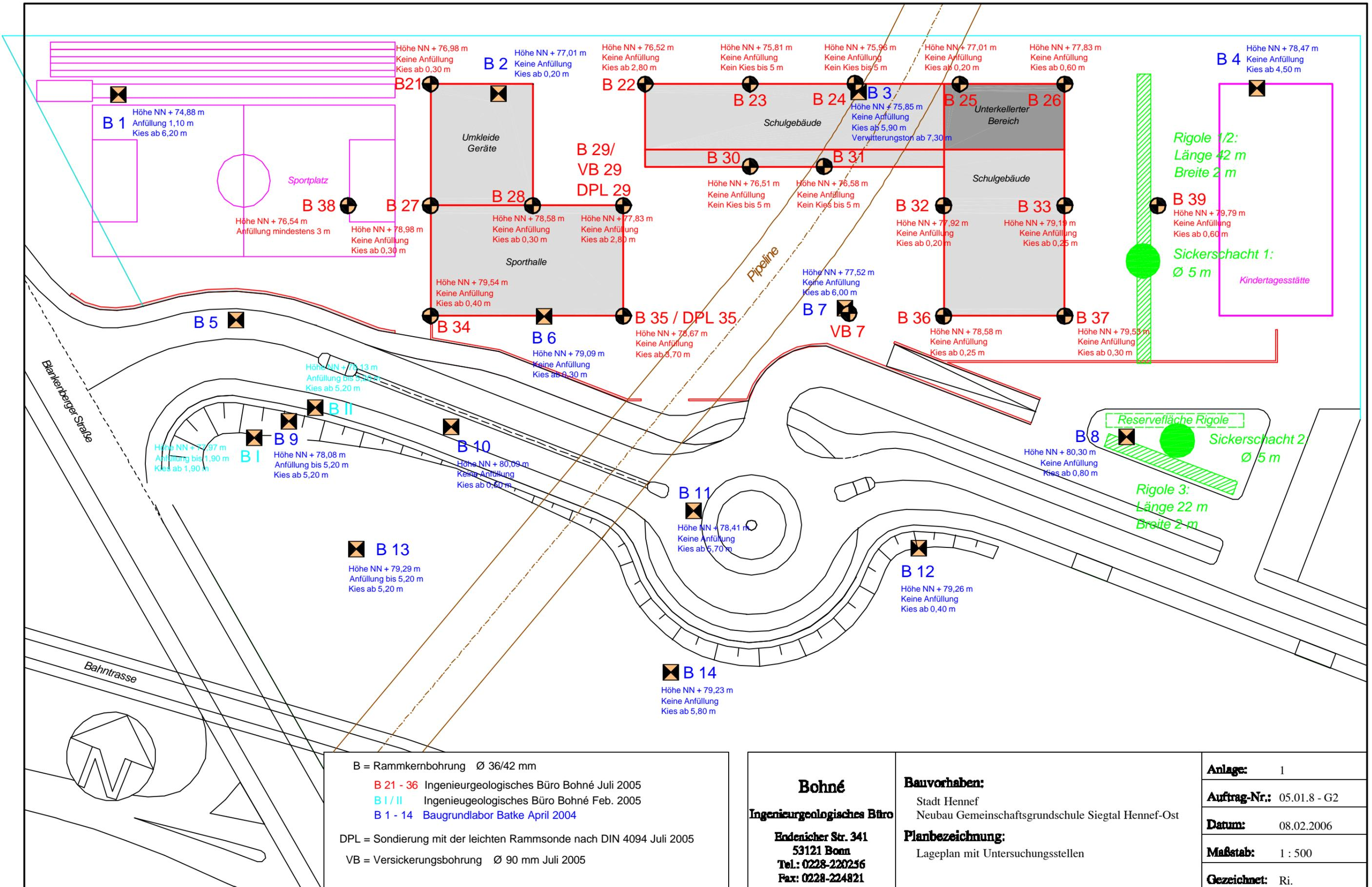
B = Rammkernbohrung Ø 36/42 mm
